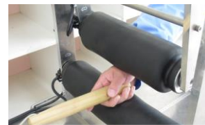
ローラー巻き込まれ
