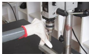
ボール盤巻き込まれ
